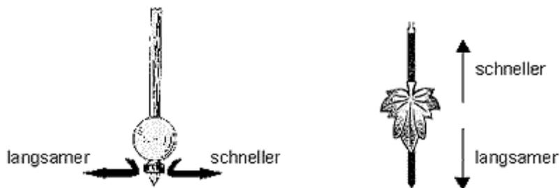
Votre coucou est déjà préréglé, mais vous effectuez vous-même le réglage fin en observant votre horloge sur une période de 24 heures. Si l'horloge bouge trop vite, poussez un peu le disque du pendule (3a) vers le bas. Si l'horloge avance trop lentement, remontez un peu le disque du pendule. Pour les coucous à pendule métallique, tournez l'écrou du pendule vers la droite (plus vite) ou vers la gauche
